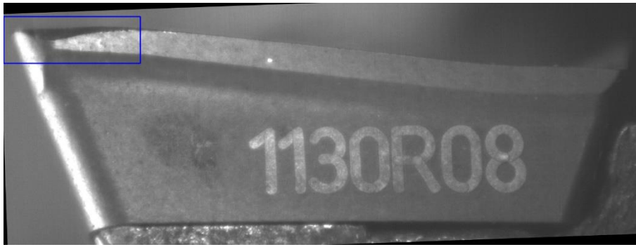
Figuur 59: Slijtage afzonderen uit snijplaatje
