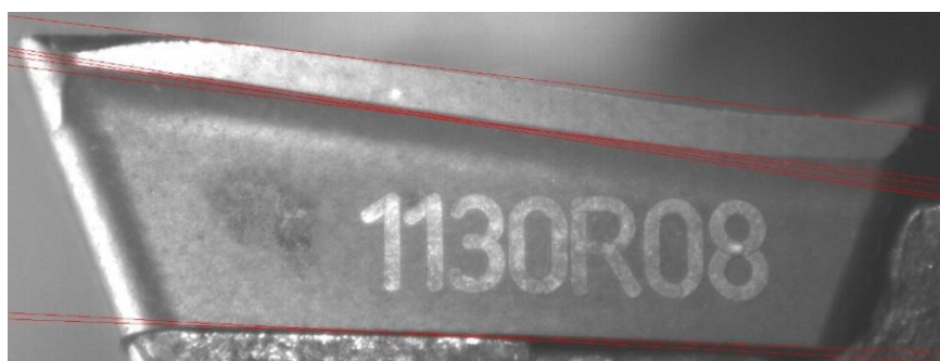
Figuur 56: Hough lijn transformatie met grenswaarde = 500
