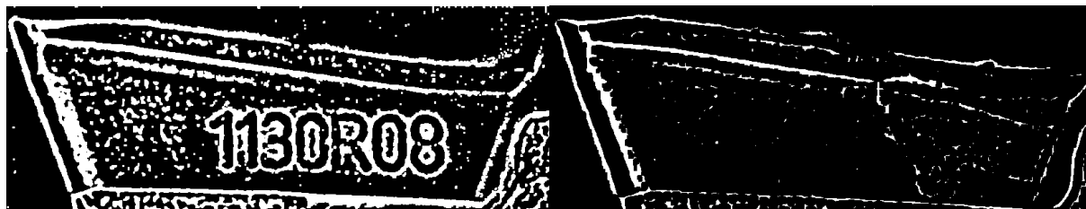
Figuur 55: Morfologische operatie openen (links) en erosie (rechts)
