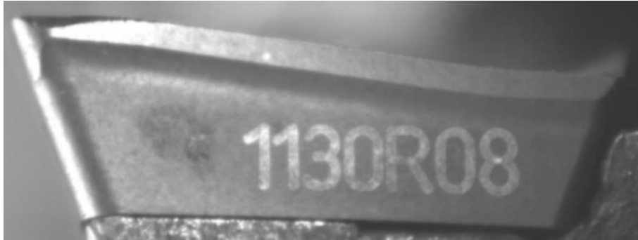
Figuur 51: Anisotropic diffusion met iteraties = 15, kappa = 70 en gamma = 0,2
