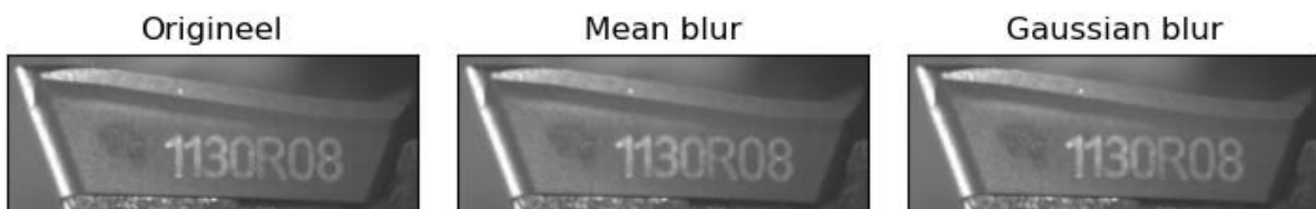
Figuur 23: Mean blur en Gaussian blur
