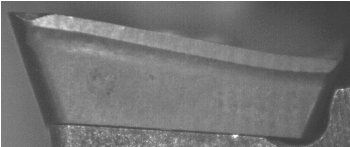
Figuur 45: Contrast tussen slijtage en omgeving vergroten door omgeving te overbelichten
