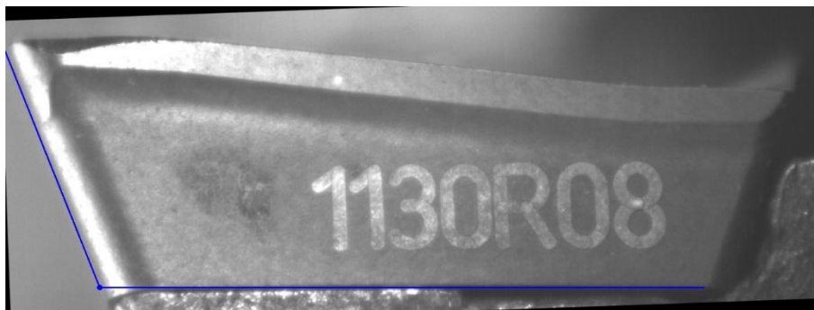
Figuur 58: Geroteerd snijplaatje met aangrijppunt
