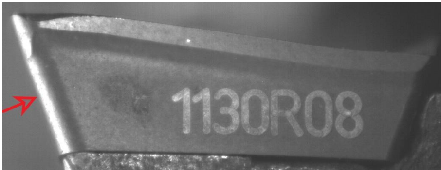
Figuur 47: Belicht snijplaatje
