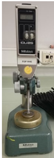
Figuur 19: Mitutoyo IDU25 diktemeter
