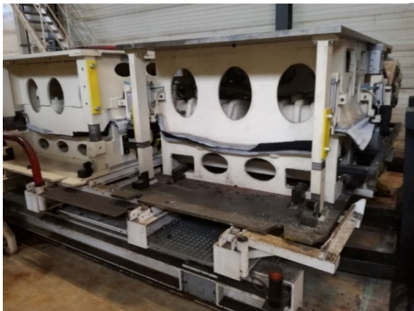
Figuur 30: Vormpers trolley twee posities
