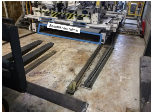
Figuur 31: Vormperstrolley en vorklift positie
