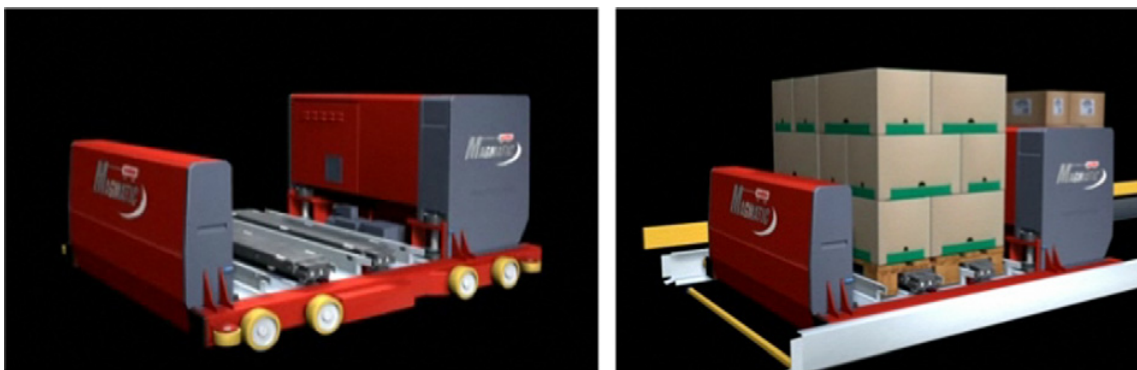
Figuur 20: De autonome shuttles in een horizontaal AVS/RS-systeem
