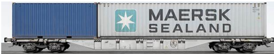
Figuur 1: Voorstelling zij aanzicht twee-bogie wagon met een totale lengte van 60 voet, gevuld door respectievelijk een 20- en een 40-voetcontainer (Container carrier)
