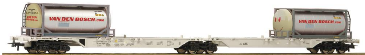
Figuur 2: Voorstelling zij aanzicht drie-bogie wagon met een totale lengte van 90 voet, links en rechts beladen door een 20-voetcontainer (HO & OO spoor)
