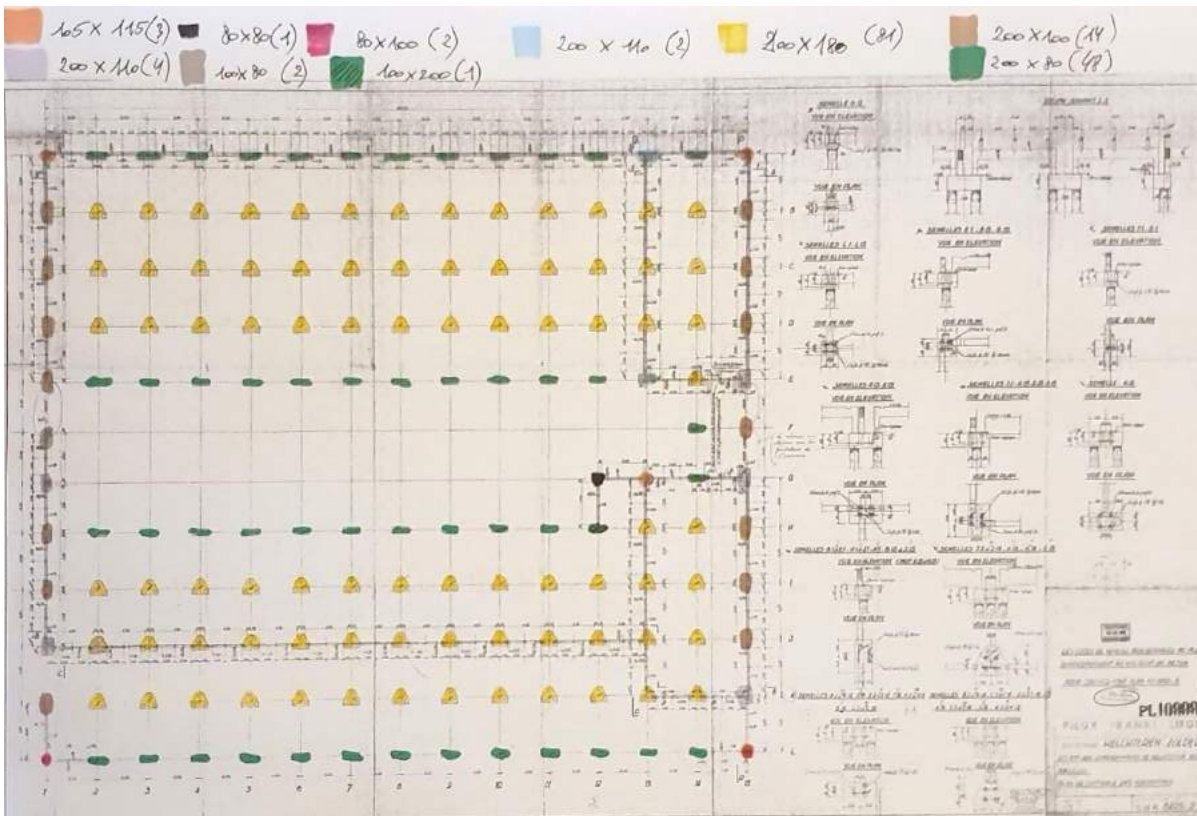
Tekening 127: Funderingszolen bestaande gebouw (eigen tekening, 2020).
