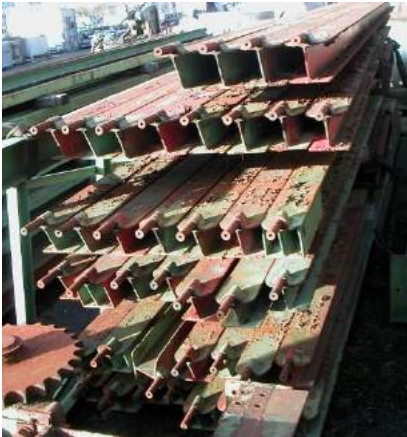
Afbeelding 54: Stalen liggers oude textielmachine (Superuse, 2020).
