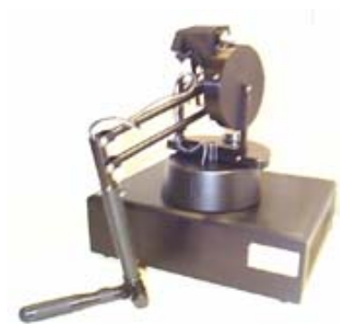
Figuur 2.4: Een SensAble PHANTOM Premium 1.5 met 6 DOF
