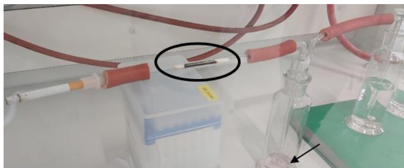
Figuur 6: Opstelling van het experiment om NO 2 te verzamelen, geproduceerd door een sigaret. De actieve kool (omcirkeld) werd tussen de sigaret en eerste wasfles geplaatst. In deze wasfles werd vervolgens 20 ml van GS-reagens geplaatst (zie pijl).
