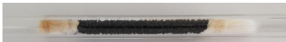
Figuur S2: Actieve kool met de gele aanslag. De actieve kool heeft de gele dampen opgenomen waardoor er een duidelijke paarse kleur gedetecteerd kon worden.
