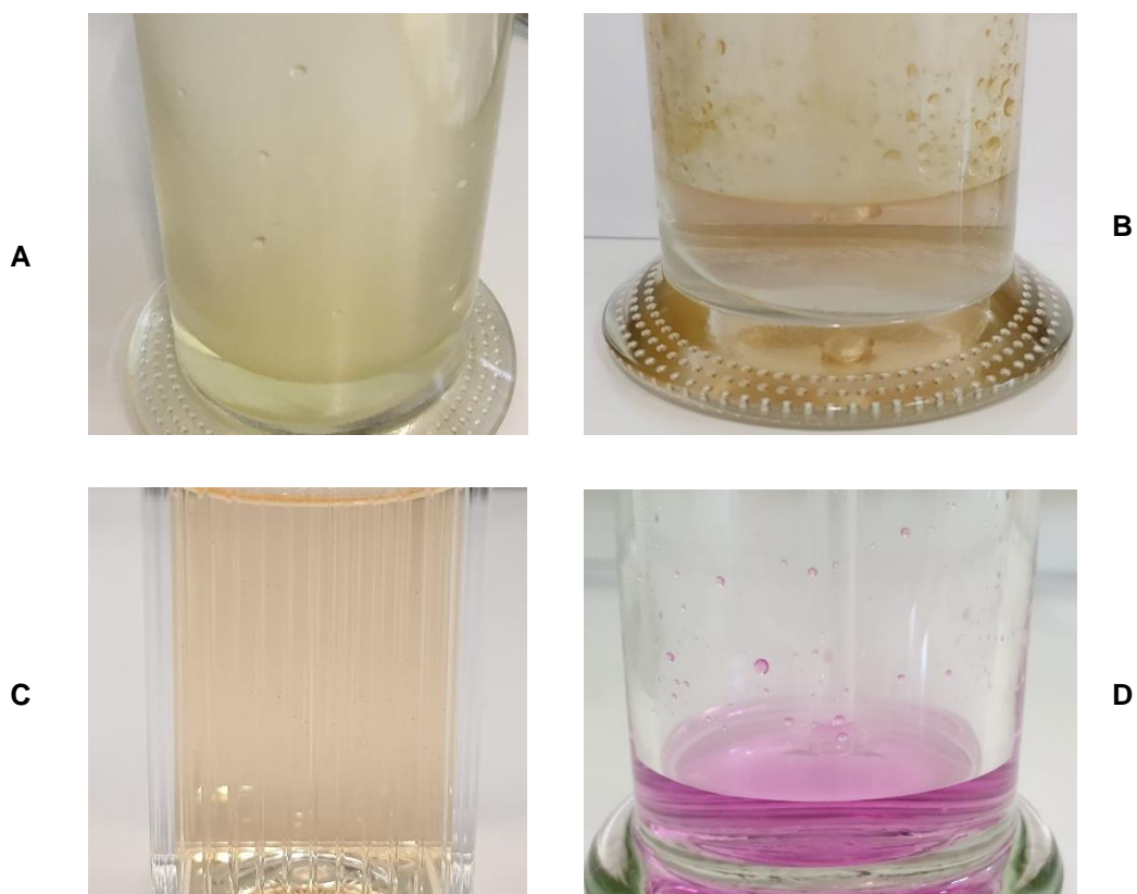
Figuur 17: NO 2 geproduceerd door sigaretten. (A) Staal met TEA produceerde geen karakteristieke paarse kleur, (B) Staal zonder TEA produceerde een lichtpaarse kleur, (C) Staal zonder TEA produceerde een paarse kleur maar interfereert met de gele rook, (D) Staal zonder TEA produceerde de karakteristieke paarse kleur. Bij dit staal werd actieve kool gebruikt en geen gele rook of aanslag werd gedetecteerd. Deze gele aanslag is wel duidelijk zichtbaar in opstelling A, B en C.
