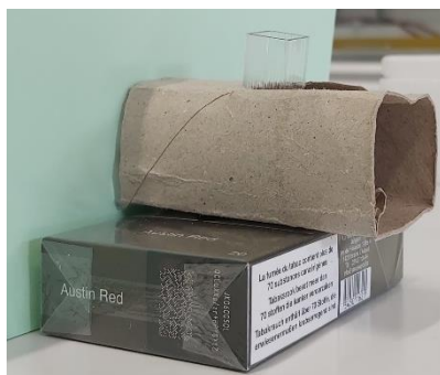
Figuur 7: De gebruikte opstelling om de absorptie te bepalen met behulp van de app ColorMeter Free.
