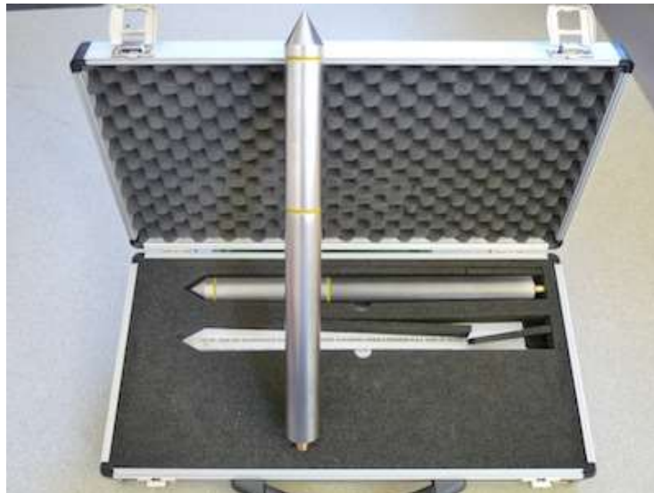
Figuur 2: Elektrische sondeersonde
