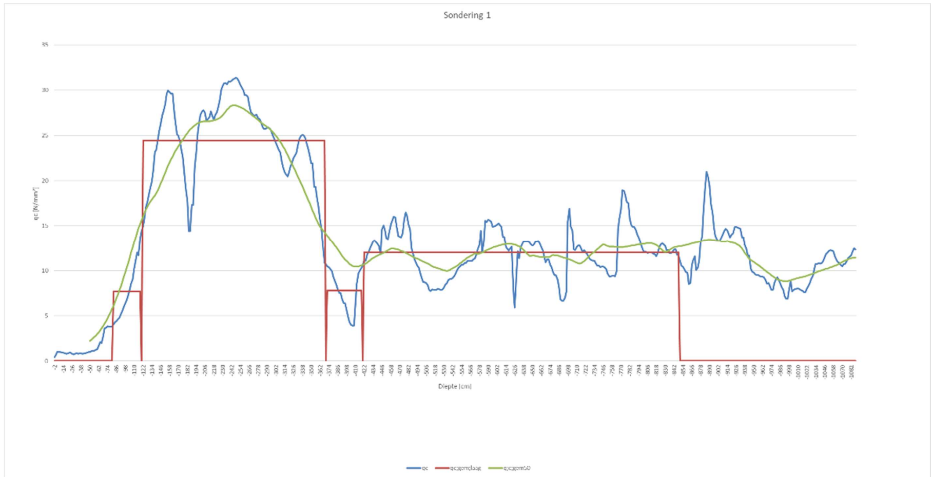
Figuur 24: Vergelijking methodes interpretatie sonderingen
