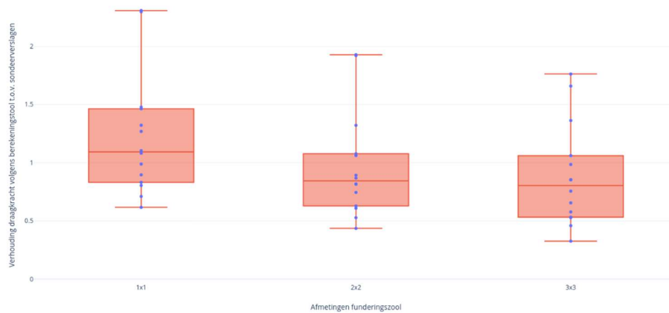
Figuur 20: Resultaten effect afmetingen zool met opsplitsing breedte
