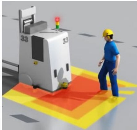
Figuur 2-11: Zones van Veiligheidslaserscanners [14]
