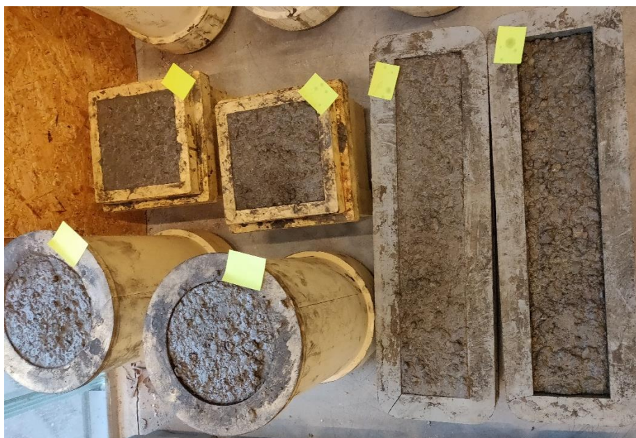
Figuur 23: Gevulde mallen - Referentiebeton.
