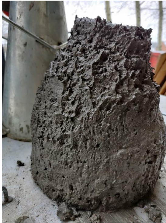
Figuur 34: Oppervlak 56% maximum hoeveelheid SP - CNT-mengsel & MasterEase3650.
