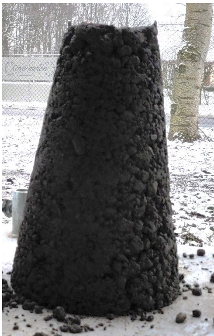
Figuur 24: Minimale hoeveelheid MasterRheobuild1100.
