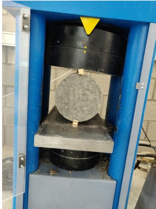
Figuur 41: Proefopstelling - Splijttrekproef.
