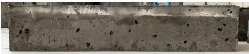
Figuur 56: Oppervlak prisma - CNT-mengsel & MasterEase3650.
