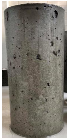
Figuur 55: Oppervlak cilinder - CNT-mengsel & MasterEase3650.
