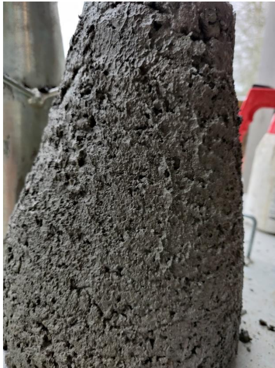
Figuur 33: Oppervlak 40% maximum hoeveelheid SP - CNT-mengsel & MasterEase3650.
