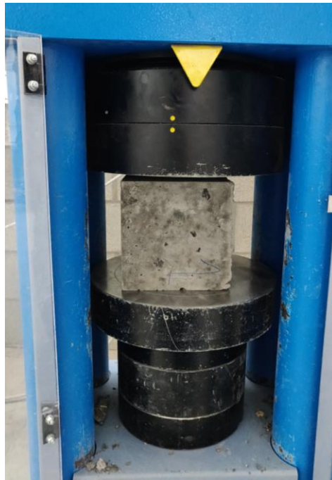
Figuur 39: Proefopstelling - Drukproef.
