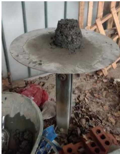
Figuur 5: Schudmaat van CNT-mengsel met 0,10%wt na uitvoering schudmaat [1, p. 54].
