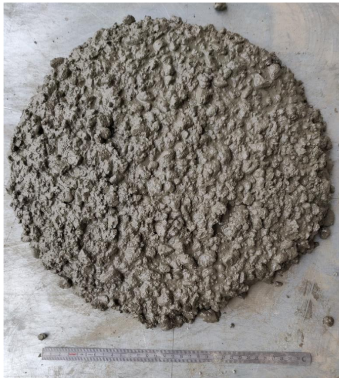
Figuur 35: Schudmaat met 56% van maximum hoeveelheid - CNT-mengsel & MasterEase3650.
