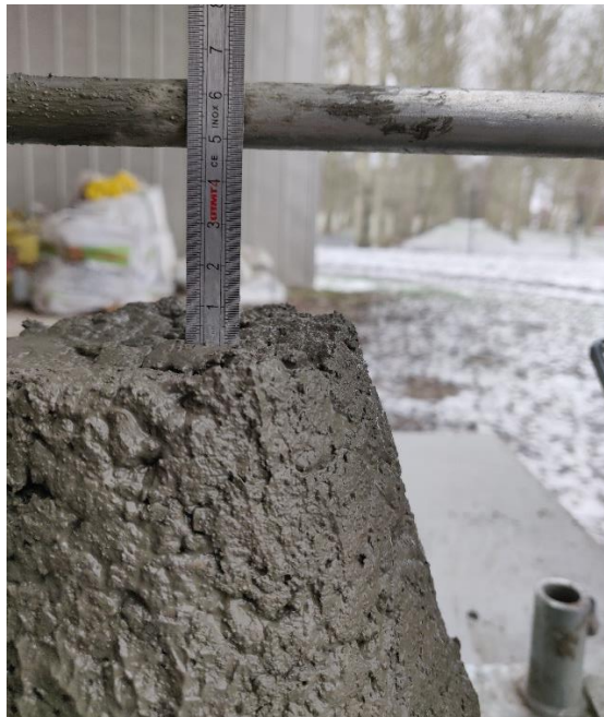
Figuur 31: Zetmaat voor 40% maximale hoeveelheid SP – CNT-mengsel & MasterEase3650.
