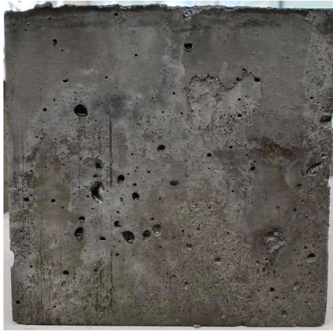
Figuur 54: Oppervlak kubus - CNT-mengsel & MasterEase3650.
