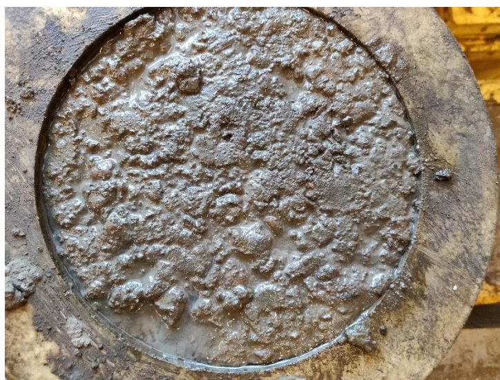
Figuur 27: Oppervlakte uitzicht - CNT-mengsel & MasterRheobuild1100.
