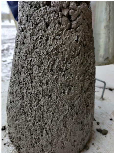
Figuur 26: Oppervlakte uitzicht na zetmaat - CNT-mengsel & MasterRheobuild1100.
