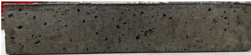
Figuur 53: Oppervlak prisma - CNT-mengsel & MasterRheobuild1100.
