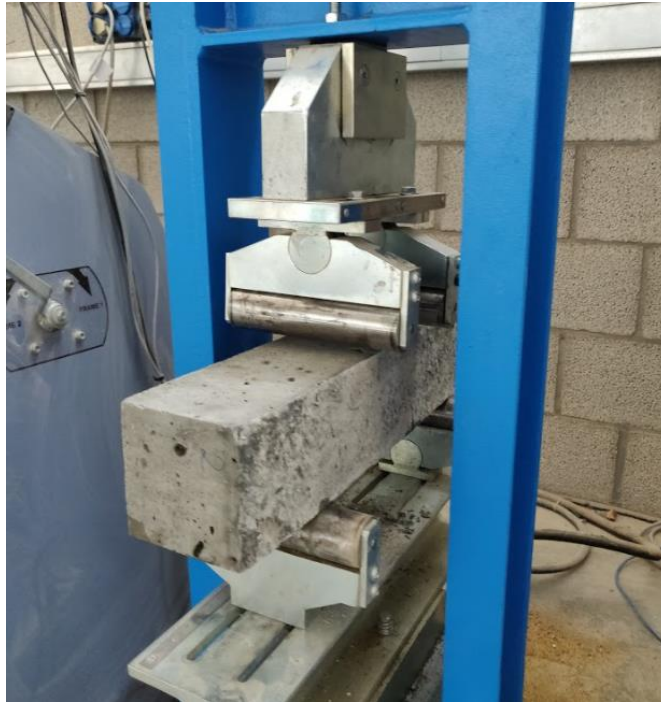
Figuur 44: Proefopstelling – 4-puntsbuigproef.
