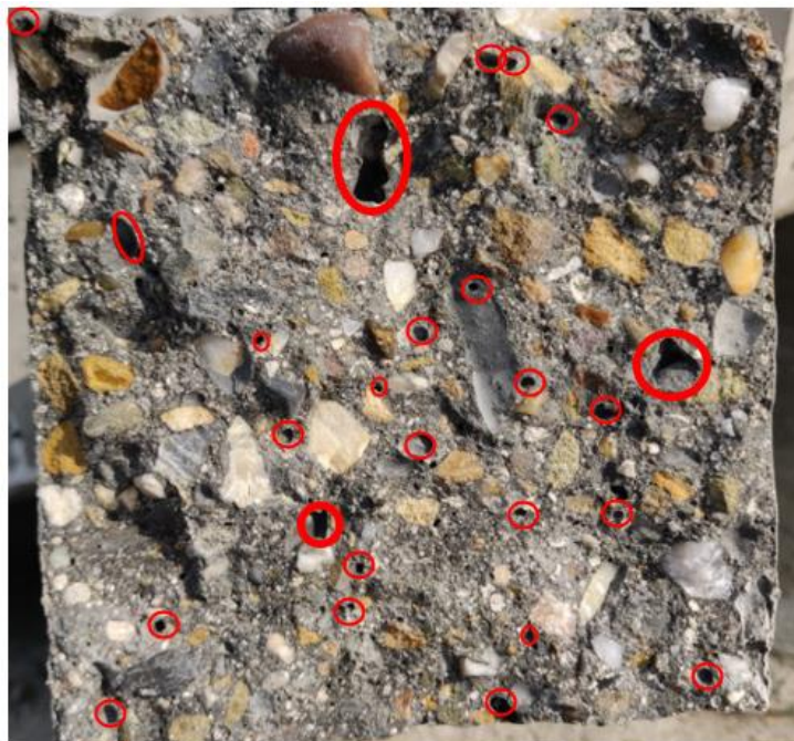
Figuur 59: Kernholtes - CNT-mengsel met MasterEase3650.
