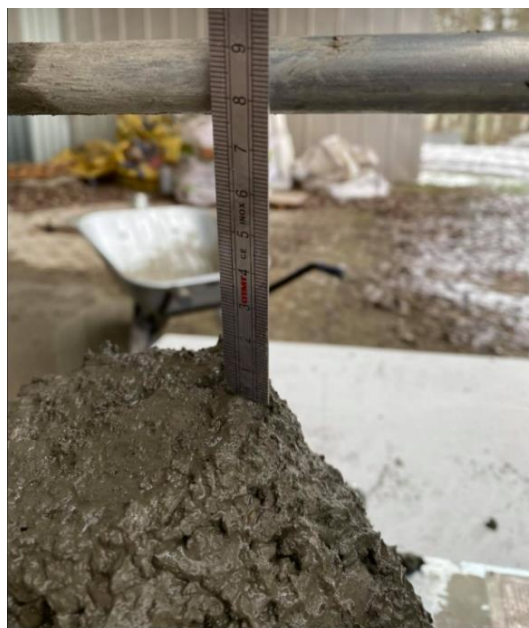
Figuur 32: Zetmaat voor 56% maximale hoeveelheid SP - CNT-mengsel & MasterEase3650.
