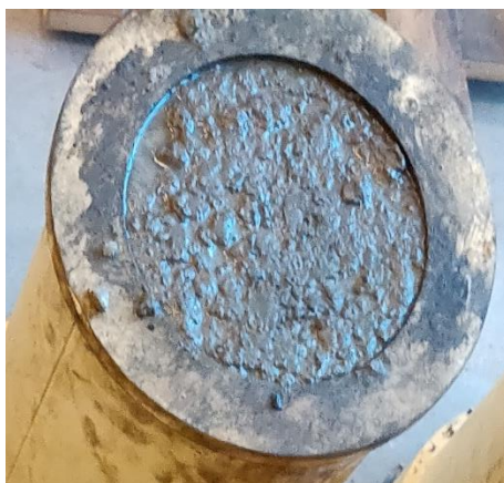
Figuur 22: Oppervlakte uitzicht in mal – Referentiebeton.
