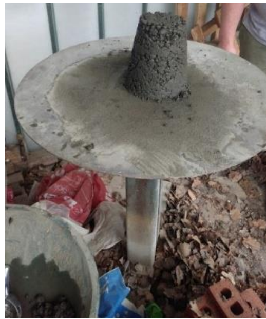
Figuur 4: CNT-mengsel 0,10%wt voor uitvoering schudmaat [1, p. 54].
