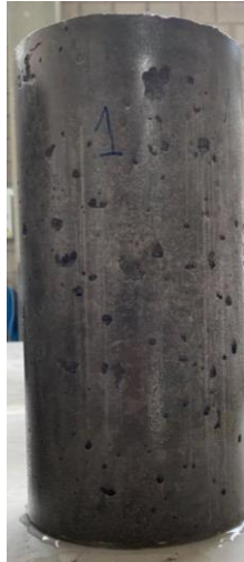
Figuur 50: Oppervlak cilinder – Referentiebeton.
