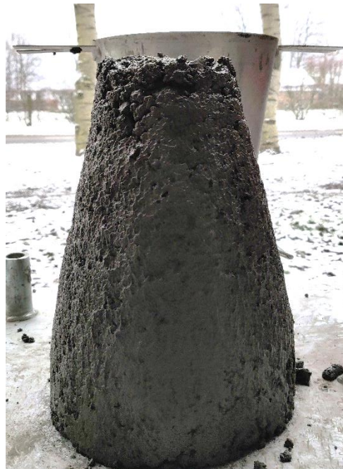
Figuur 25: zetmaat - CNT-mengsel & MasterRheobuild1100.
