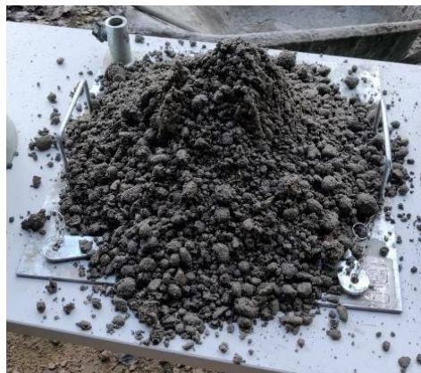
Figuur 19: Zetmaat met gedroogde granulaten - Referentiebeton.
