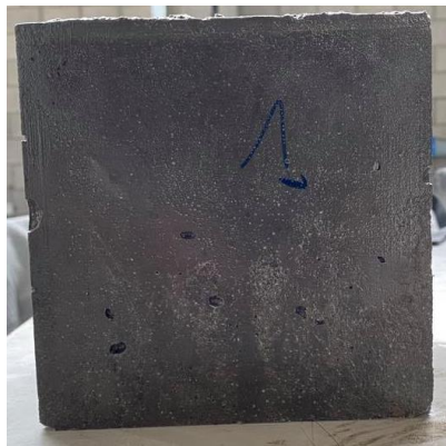
Figuur 48: Oppervlak kubus - Referentiebeton.
