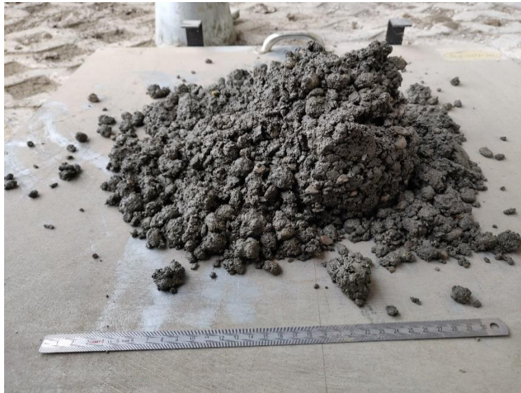
Figuur 28: Schudmaat voor toevoeging MasterRheobuild1100.
