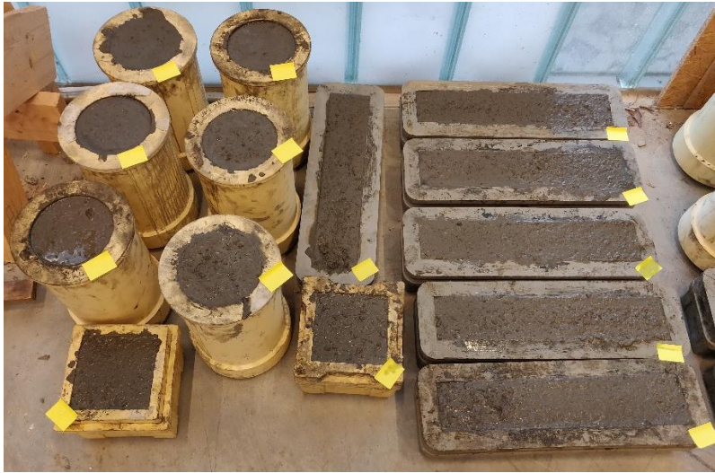
Figuur 36: Mallen met betonmengsel - CNT-mengsel & MasterEase3650.
