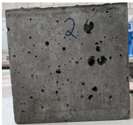
Figuur 51: Oppervlak kubus - CNT-mengsel & MasterRheobuild1100.
