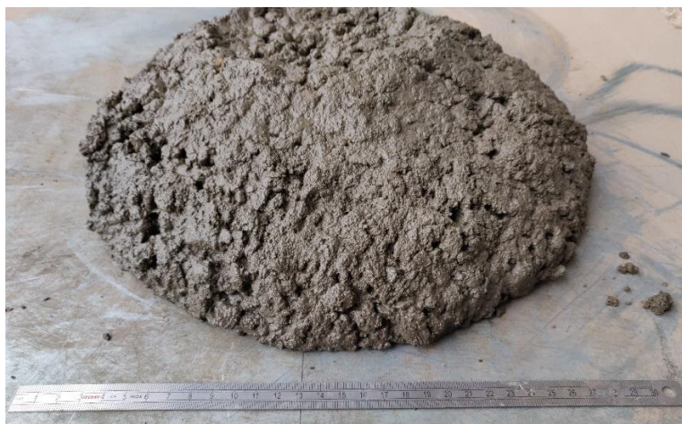
Figuur 29: Schudmaat na toevoeging 100% MasterRheobuild1100.
