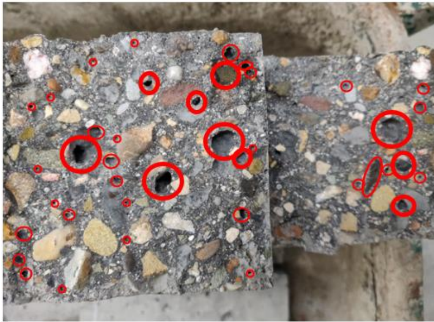
Figuur 58: Kernholtes - CNT-mengsel met MasterRheobuild1100.
