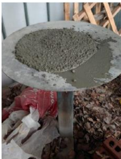
Figuur 17: Schudmaat referentiebeton voorgaande masterproef [1, p. 54].
