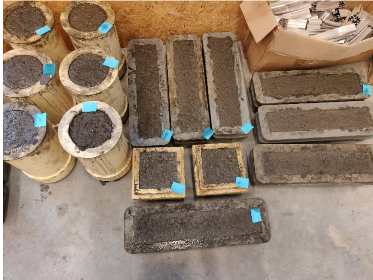
Figuur 30: Mallen met betonmengsel - CNT-mengsel & MasterRheobuild1100.
