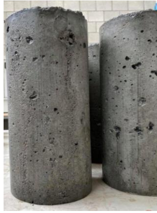
Figuur 52: Oppervlak cilinder - CNT-mengsel & MasterRheobuild1100.
