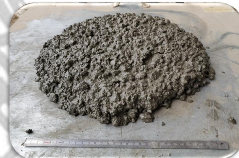
Fig. 3: CNT-mengsel met polycarboxy SP
