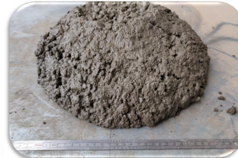
Fig. 2: CNT-mengsel met naftaleen SP MasterEase 3650
