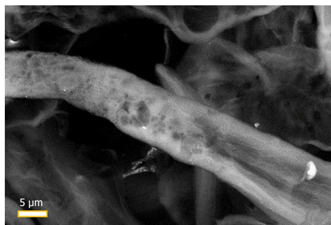
Figuur 77: SEM-beeld van pellets met kleine nanopartikels en cellulose 2.000x vergroot op schaal van 5 µm
