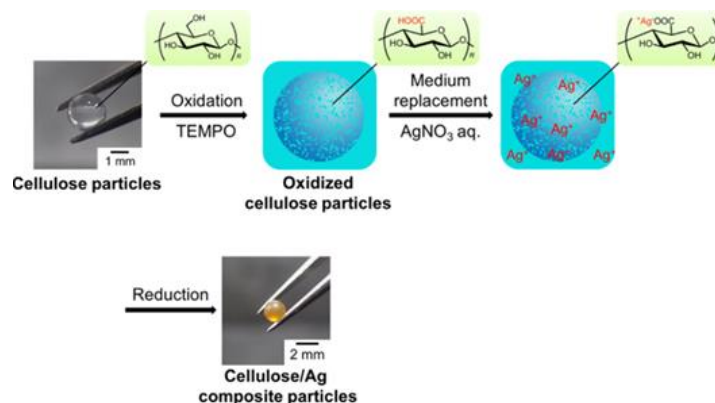
Figuur 13: Productie van cellulose-zilvernanocomposieten met behulp van TEMPO [4, p. 1919]
