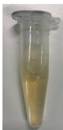
Figuur 29: Gescheiden kleine zilvernanopartikels door middel van microcentrifuge
