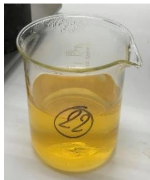
Figuur 28: Illustratie van de kleur van de suspensie van kleine zilvernanopartikels
