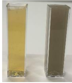
Figuur 30: Kleurvergelijking tussen kleine zilvernano-partikels (links) en grote zilvernano-partikels (rechts)
