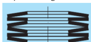
Figuur 95: Progressief gedrag door het gebruiken van platte plaatjes [43, p. 40]
