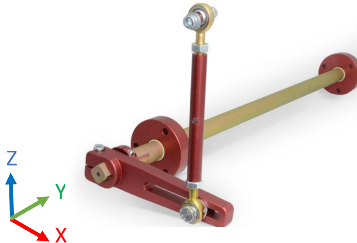
Figuur 13: Stabilisatorstang met veranderlijke armlengte [18, p. 9]
