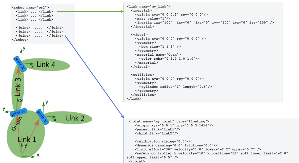
Figuur 12: XML-code van een typische robot [15]
