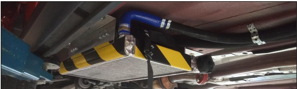
Figuur 56: Huidige positie radiator in-wielmotoren (Bron: Flanders Make)
