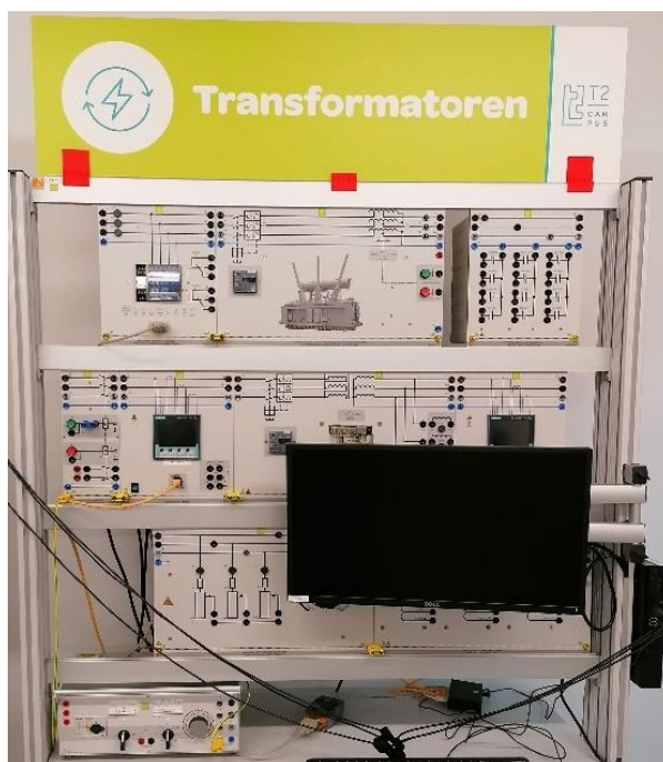
Figuur 30: Transformatoren proeftafel
