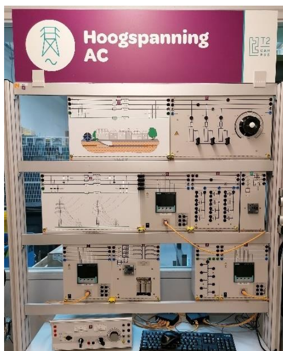
Figuur 31: HVAC proeftafel
