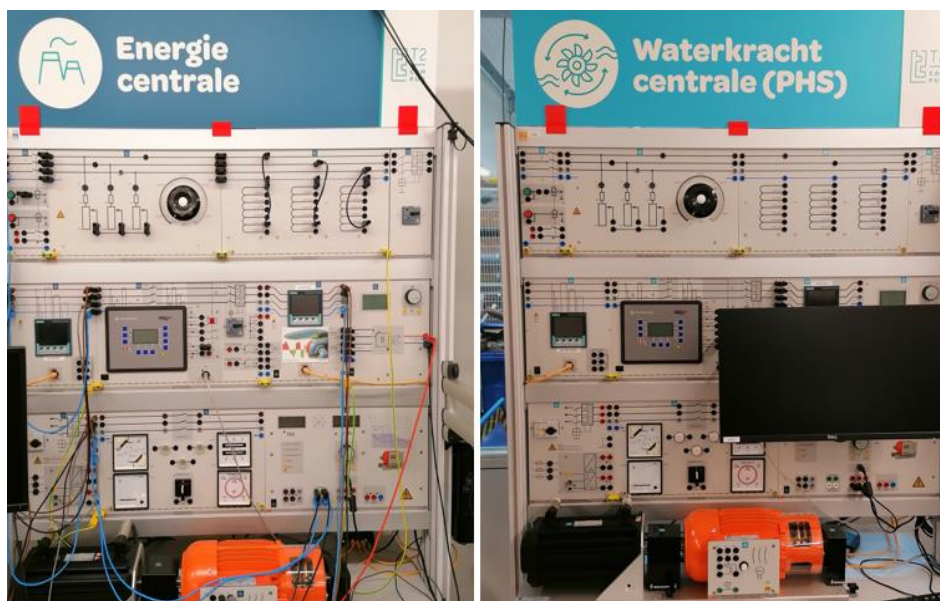
Figuur 29: Energiecentrale en waterkrachtcentrale proeftafels
