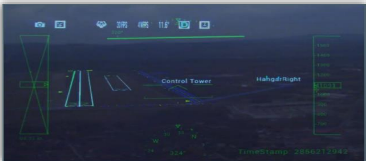
Figuur 1: AR Navigatie. Piloten kunnen luchtnavigatie data zien door hun HMDs (Agrawal, 2018)
