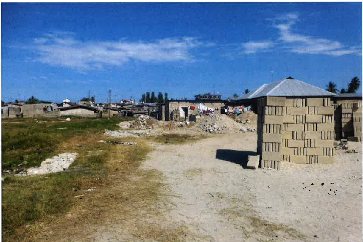
Figuur 56: Productie van betonblokken in de informal settlements van Msasani
