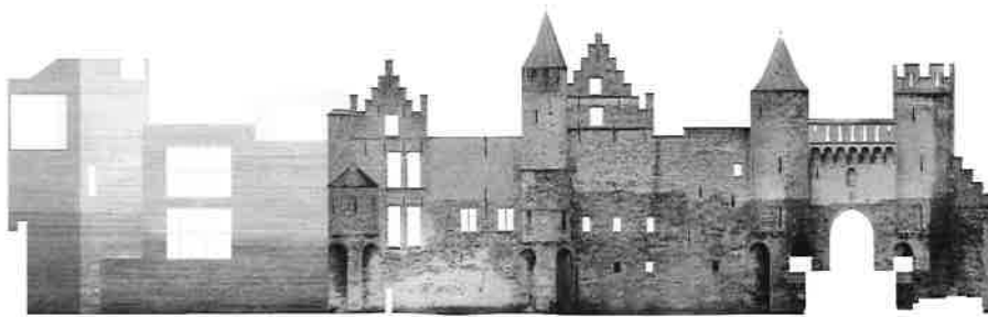
Fig. 47 Kleurschakeringen en aansluiting van nieuwbouw en oude burcht
