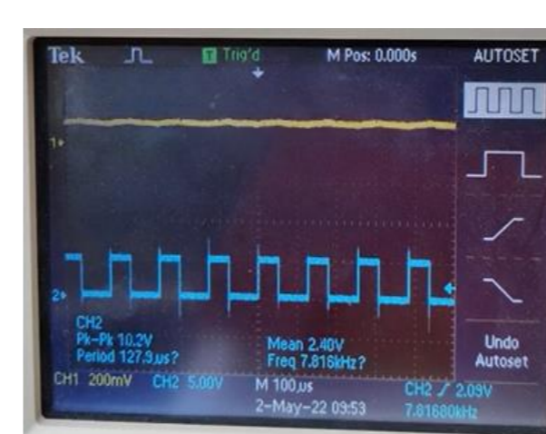
Figuur 7: PWM-spanning spoel (blauw) en spoelstroom (geel)
