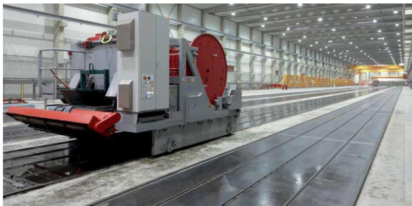
Figuur 21: Slipformmachine op voorspanbed [5]
