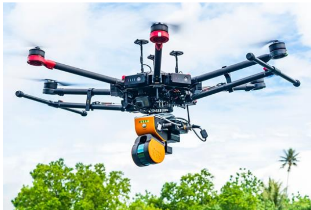
Figuur 21: GeoSLAM Horizon in combinatie met een drone [12]
