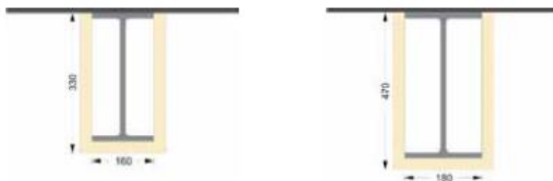
Figuur 36 Links: Stalen I profiel REI 60; Rechts: Aluminium I-vormig profiel REI 60 [17]
