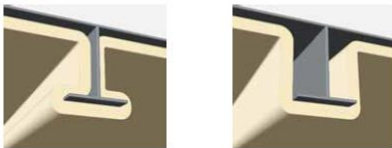
Figuur 37 Bescherming Stalen profiel en aluminium profiel met Firemaster Marine Blanket plus [17]
