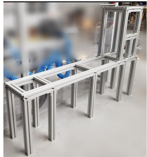
Figuur 81: Opbouw van frame voor plooiemachine, aanzicht 2
