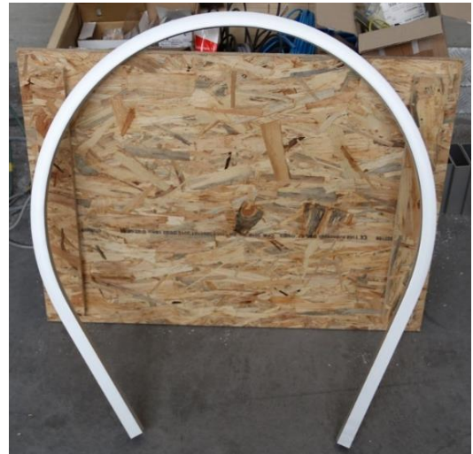
Figuur 90: Geplooiide hoepel als resultaat van test
