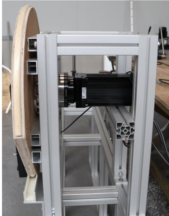
Figuur 91: Zijaanzicht van gemaakte plooiemachine met spacer tussen mal en frame
