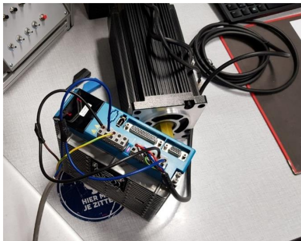
Figuur 55: Eerste test om motor m.b.v. drive te laten draaien
