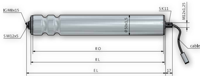
Figuur 49: Motor roller type 840-50 voor het aanvoeren van de kokers naar de plooiemachine [15]
