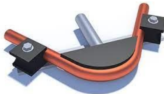
Figuur 9: Werking van ram bending 2 [7]
