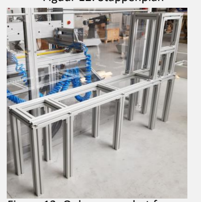
Figuur 13: Opbouw van het frame
