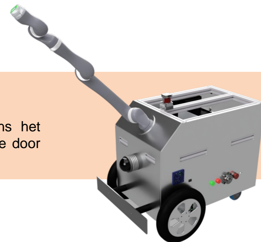
Figuur 1: Robotplatform voor het detecteren van radioactieve bronnen
