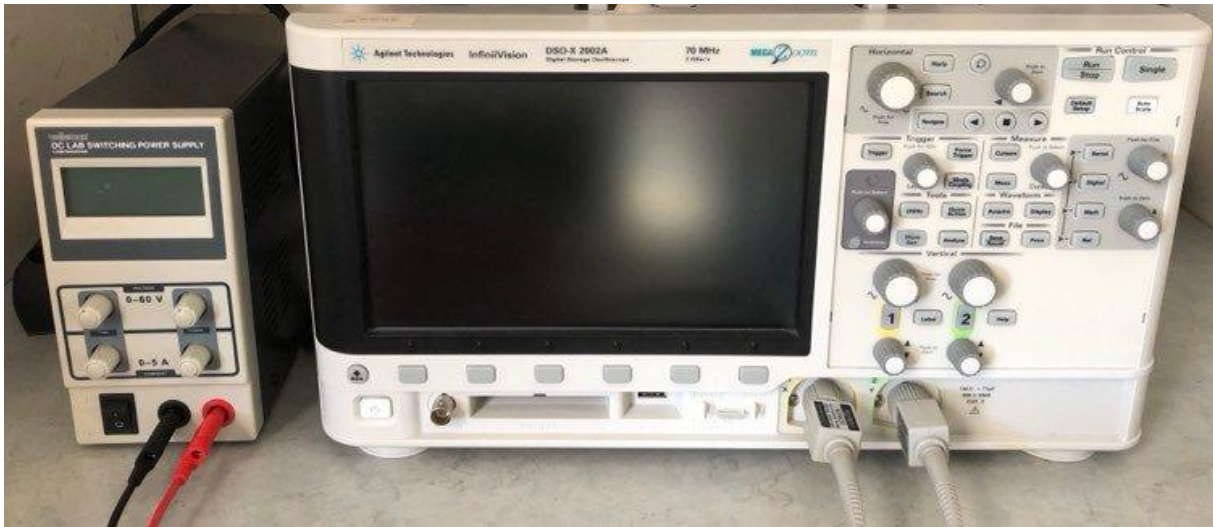
Figuur 59: DC-bron en oscilloscoop
