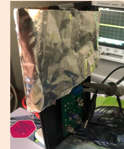
Figuur 6: Spoel afschermen met aluminiumfolie
