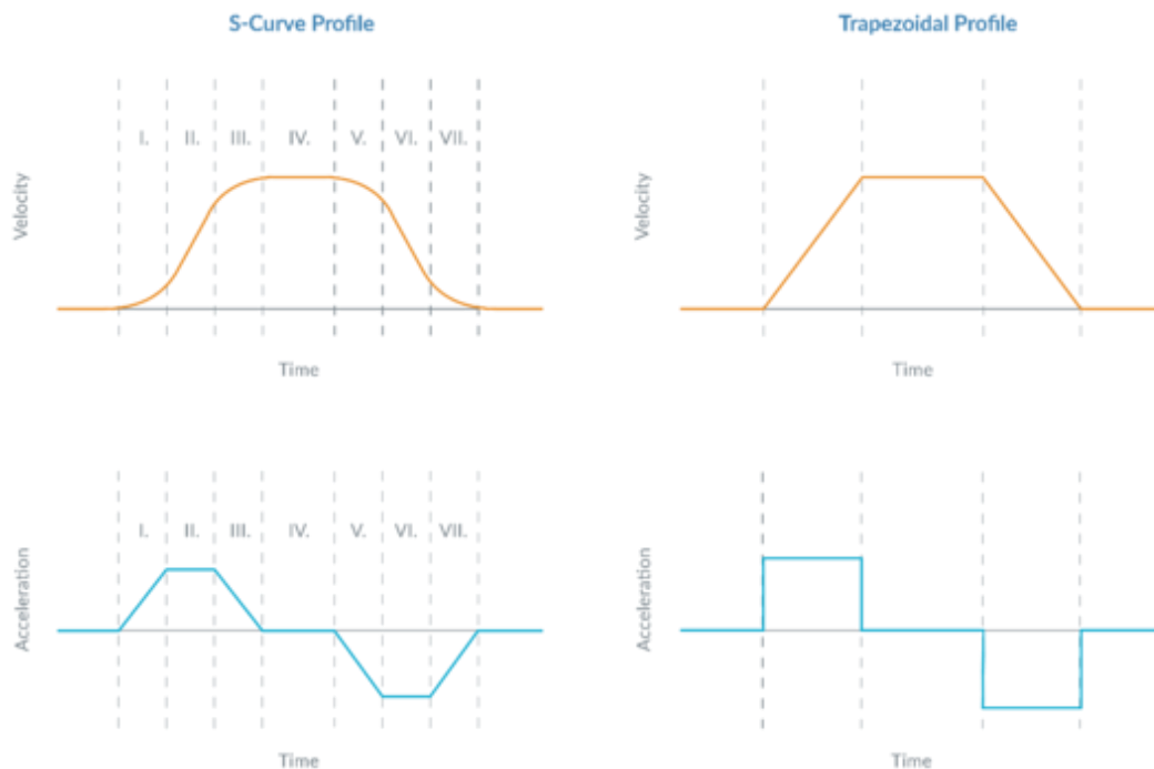
Figuur 11: Invloed van een S-curve besturing [39]
