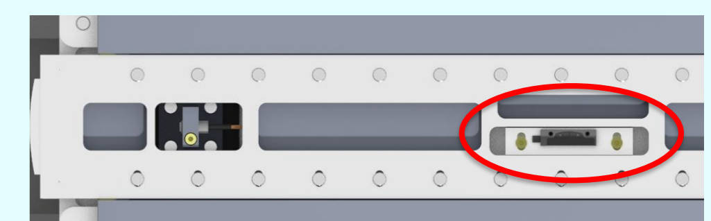
Figuur 8: Lineaire encoder in het tussenblok
