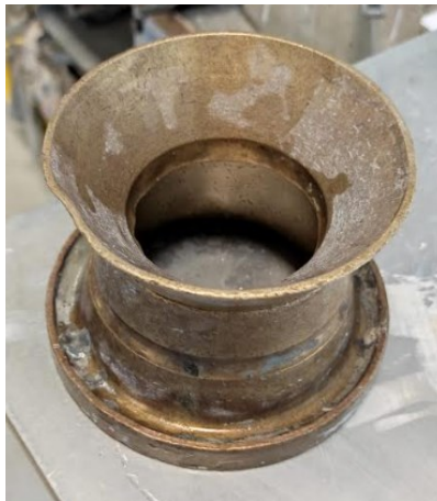
Figuur 28: Afgeknotte kegel uit messing om de vloeimaat te bepalen (NBN EN 1015-3:1999).
