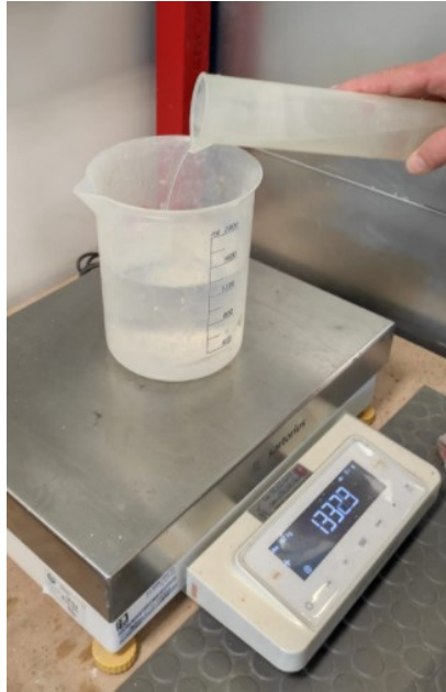
Figuur 46: Afwegen van het toe te voegen water.
