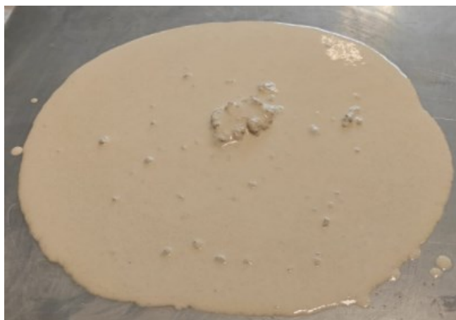
Figuur 42: Segregatie of ontmenging van de anhydrietgebonden samenstelling.
