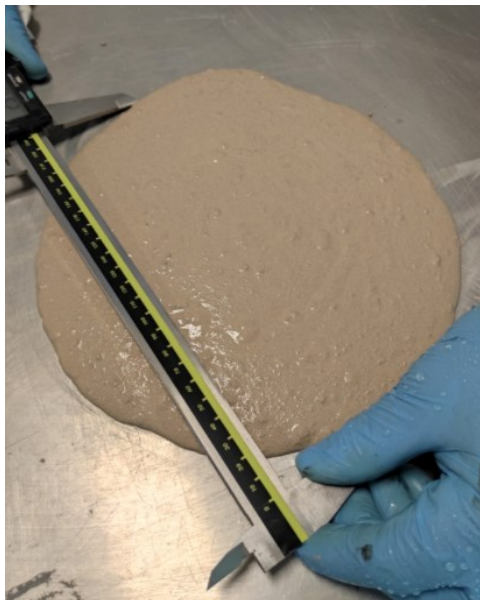
Figuur 51: Uitgevoerd mengsel waarvan de vloeimaat wordt genomen.
