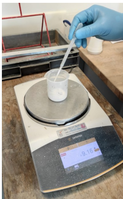
Figuur 43: Afwegen van het hydrofoob middel met gebruik van pipet.
