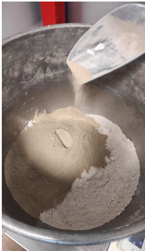
Figuur 45: Afwegen van het calciumsulfaat bindmiddel, het zand en het poreus middel
