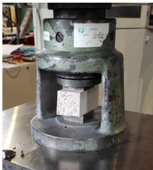
Figuur 32: Foto van de positionering voor de drukproef in de praktijk.
