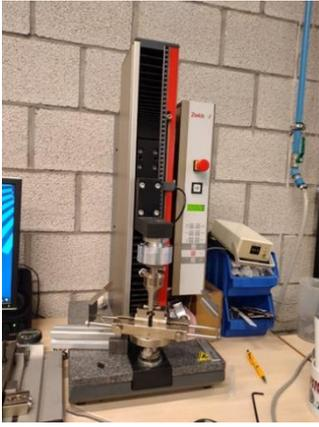
Figure 26: ZwickRoell 1486 flexibility testing machine (ZwickRoell GmbH. & Co. KG).
