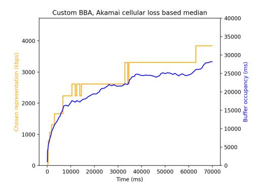
**Figuur 4:** Bufferniveau (buffer occupancy) en de gekozen representatie (chosen representation) van de eigen BBA-implementatie tijdens een videostream met een dataset van Akamai van een mobiel netwerk.
