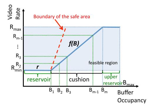
**Figuur 3:** Werking van BBA-1, door Huang e.a. 2014a. Buffer occupancy is het bufferniveau, het aantal seconden aan video dat nog in de videobuffer zit. Video rate is de bitrate van de beschikbare representaties.
