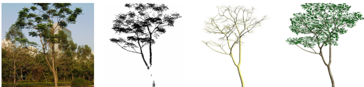
Figuur 2.4: Van links naar rechts: afbeelding boom, puntenwolk van laser, skelet reconstructie, volledige reconstructie. Bron: [Livny et al., 2010]
