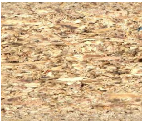
Afbeelding 82: Doorsnede spaanplaat, houtspaanders (Kabel, 2004)
