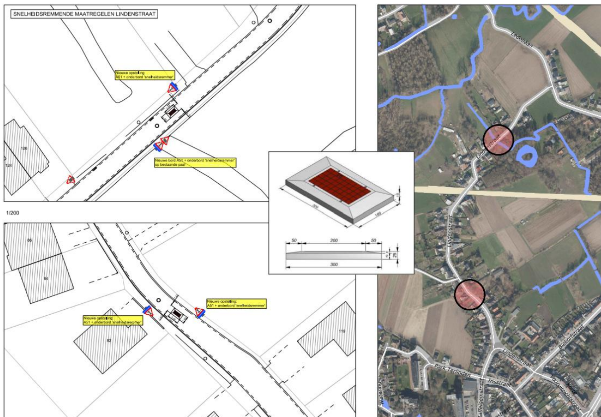
Figuur 23: Ontwerp rijbaankussen, bron: Stad Aalst
