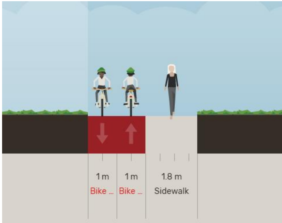
Figuur 119: Schematische tekening van de doorsnede van het verbindingspad met voetpad (Streetmix, 2022)
