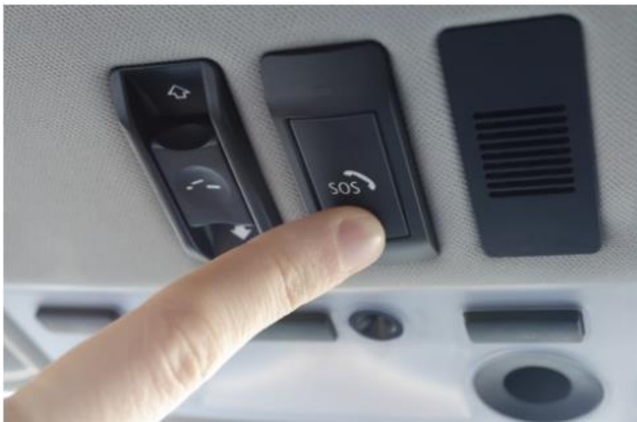
Figure 2: Ingebouwde SOS-knop in een voertuig (Texas Instruments, 2016)
