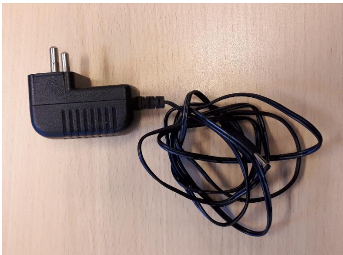
Figuur 15: De oorspronkelijke stekker van de router. Merk de vormgeving van de plastic behuizing op, die aansluiting op een stopcontact verhindert
