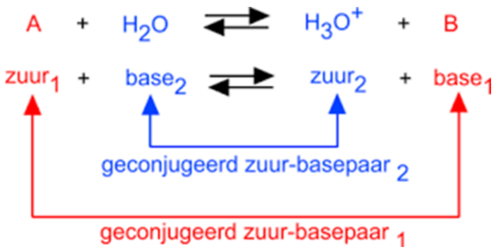
Figuur 1. Schematische voorstelling van een zuur/base reactie in water.
