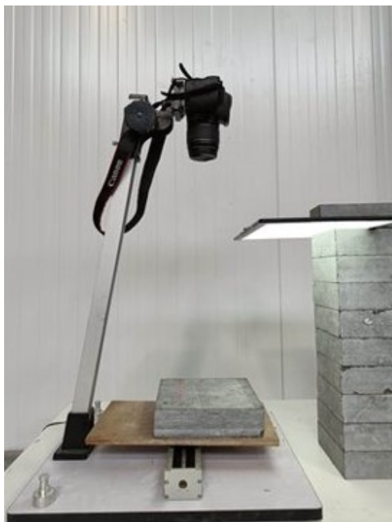
Figuur 12: Opstelling voor het maken van de afbeeldingen voor het convolutioneel netwerk
