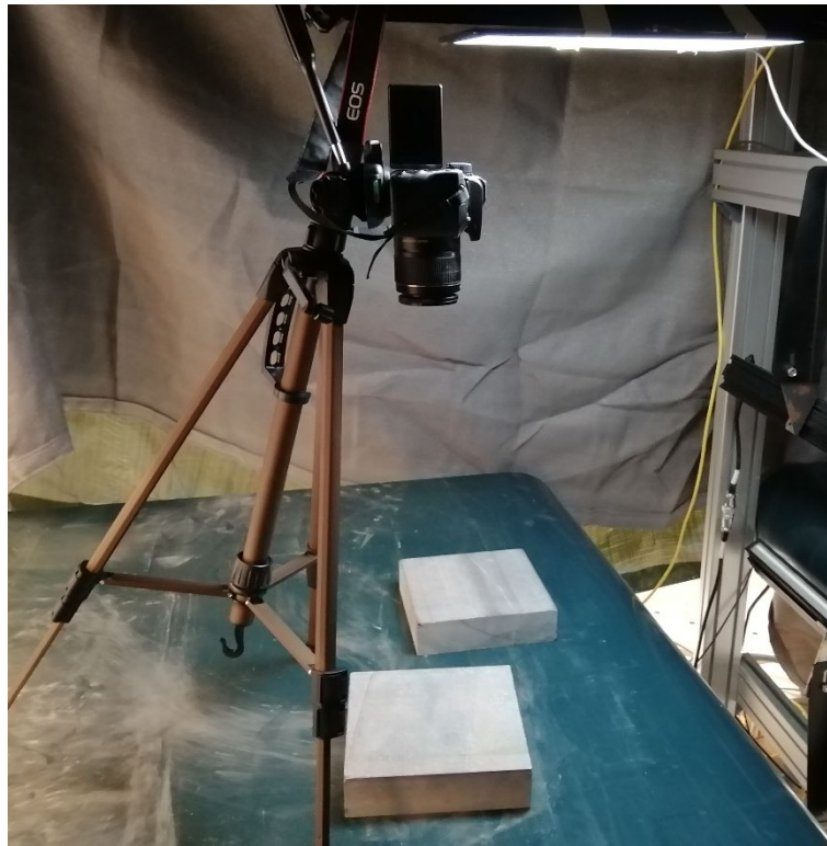
Figuur 4: Gebruikte opstelling voor het maken van foto's waarbij de stenen op de transportband liggen
