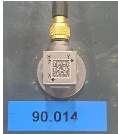
Figuur 2.7.2: Assenstelsel versnellingsmeter
