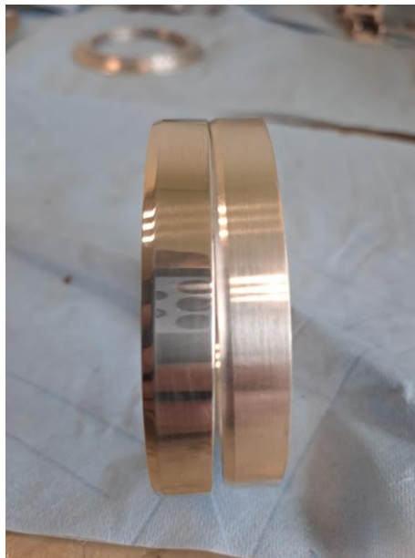
Figuur 4.4.9: Vergelijking Sleeve gepolijst (links), ruw (rechts)
