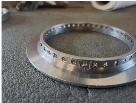
Figuur 4.4.10: Beschadiging voorspanmoer na gebruik
