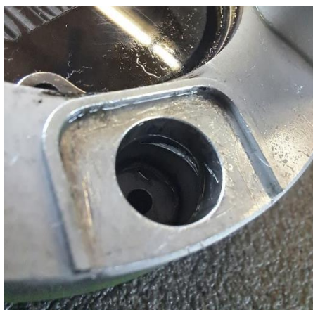
Figuur 4.4.6: Braamvorming in de Carrier
