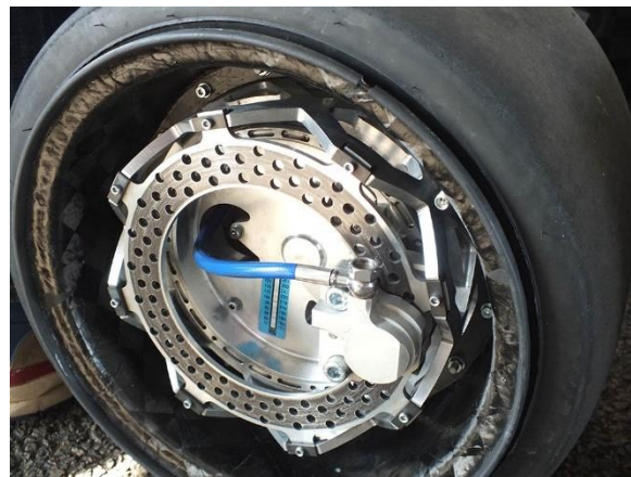
Figuur 6.3.5: Omgekeerd remsysteem TU-Delft
