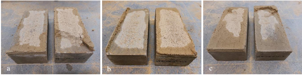
Figuur 63: Vochtfronten in mortel van couplet a) VEB4-M8-1"-1'.1, b) VEB4-M8-1"-1'.2 en c) VEB4-M8-1"-1'.3
