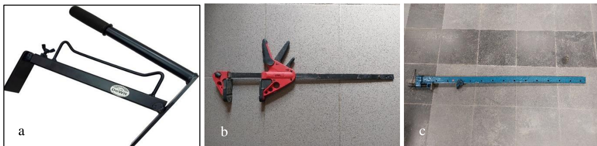
Figuur 78: Klemmen gebruikt voor iteratief demontageproces a) stenenklem, b) korte klem en c) lange klem
