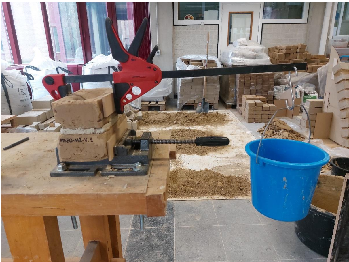
Figuur 18: Aangepaste proefopstelling (F)MEB's
