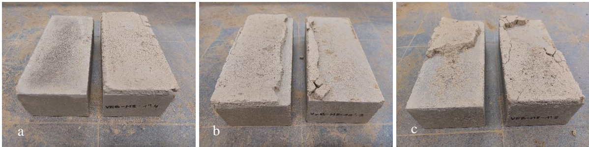
Figuur 74: Visualisatie faalmodi combinatie VEB4-M8 a) faalmodus A1, b) faalmodus A2 en c) faalmodus A3
