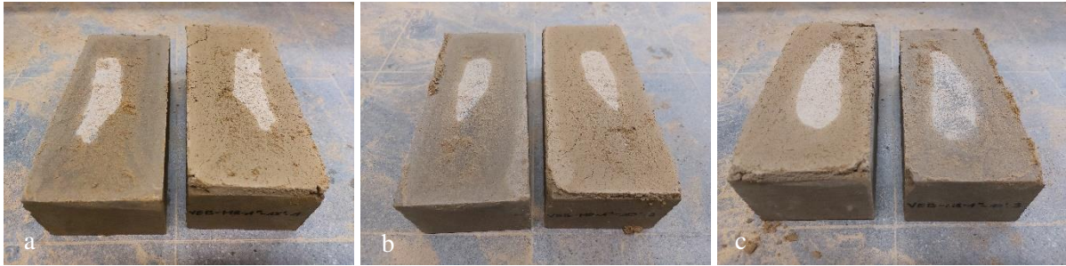
Figuur 64: Vochtfronten in mortel van couplet a) VEB4-M8-1"-15'.1, b) VEB4-M8-1"-15'.2 en c) VEB4-M8-1"-15'.3
