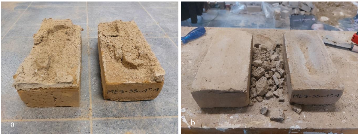
Figuur 82: Combinatie FMEB-SS a) voor zuiver maken en b) na zuiver maken
