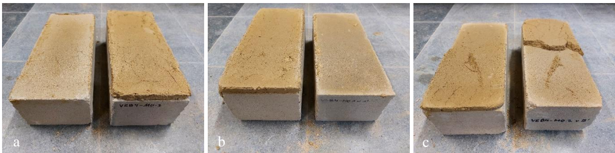
Figuur 53: Visualisatie faalmodi combinatie VEB4-M0 a) faalmodus A1, b) faalmodus A2 en c) faalmodus A3
