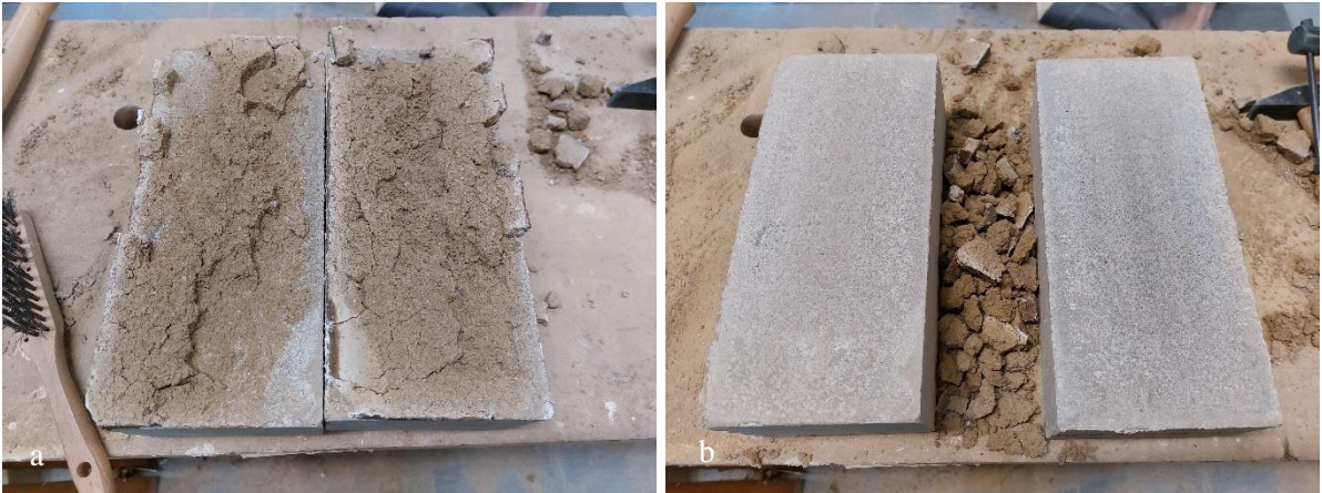
Figuur 87: Combinatie VEB4-SS a) voor zuiver maken en b) na zuiver maken
