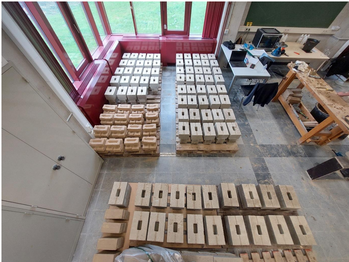
Figuur 59: Gemetste proefstukken testreeks 2
