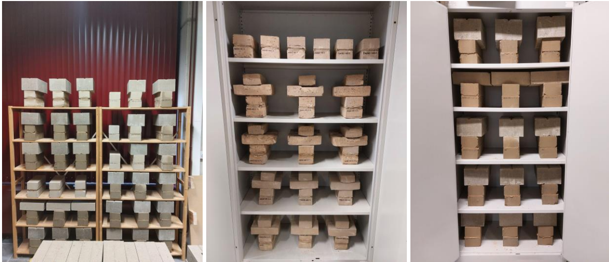
Figuur 41: Gemetste coupletten testreeks 1 (deel 2)
