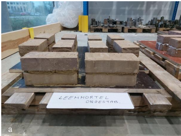
Figuur 19: Coupletten a) ongestabiliseerde leemmortel en b) gestabiliseerde leemmortel en lijm mortel
