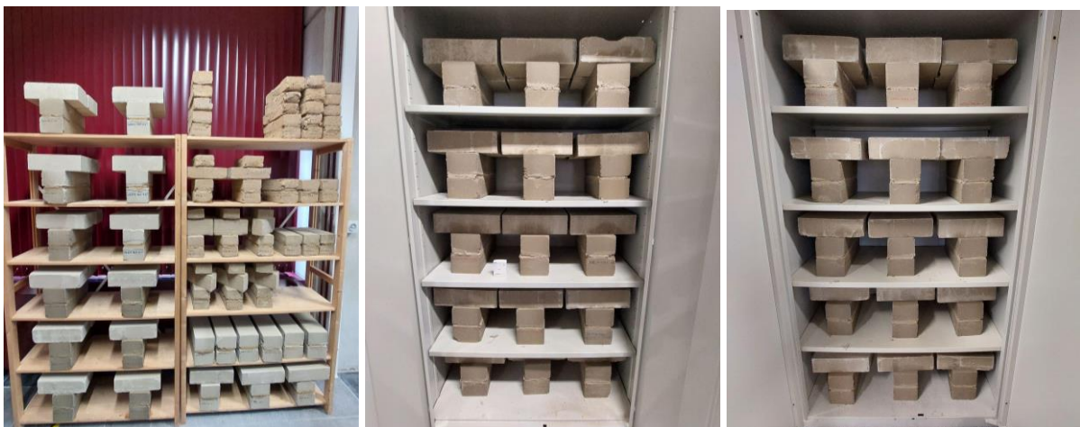
Figuur 40: Gemetste coupletten testreeks 1 (deel 1)
