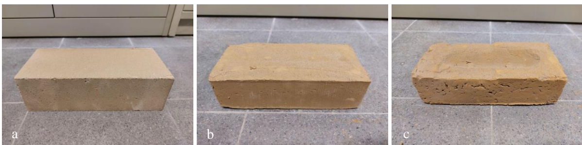
Figuur 37: a) vibro-gecompacteerde leemsteen, b) solide vormsteen en c) frogged vormsteen
