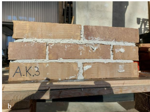
Figuur 20: Muurtje a) ongestabiliseerde leemmortel en b) kalkmortel
