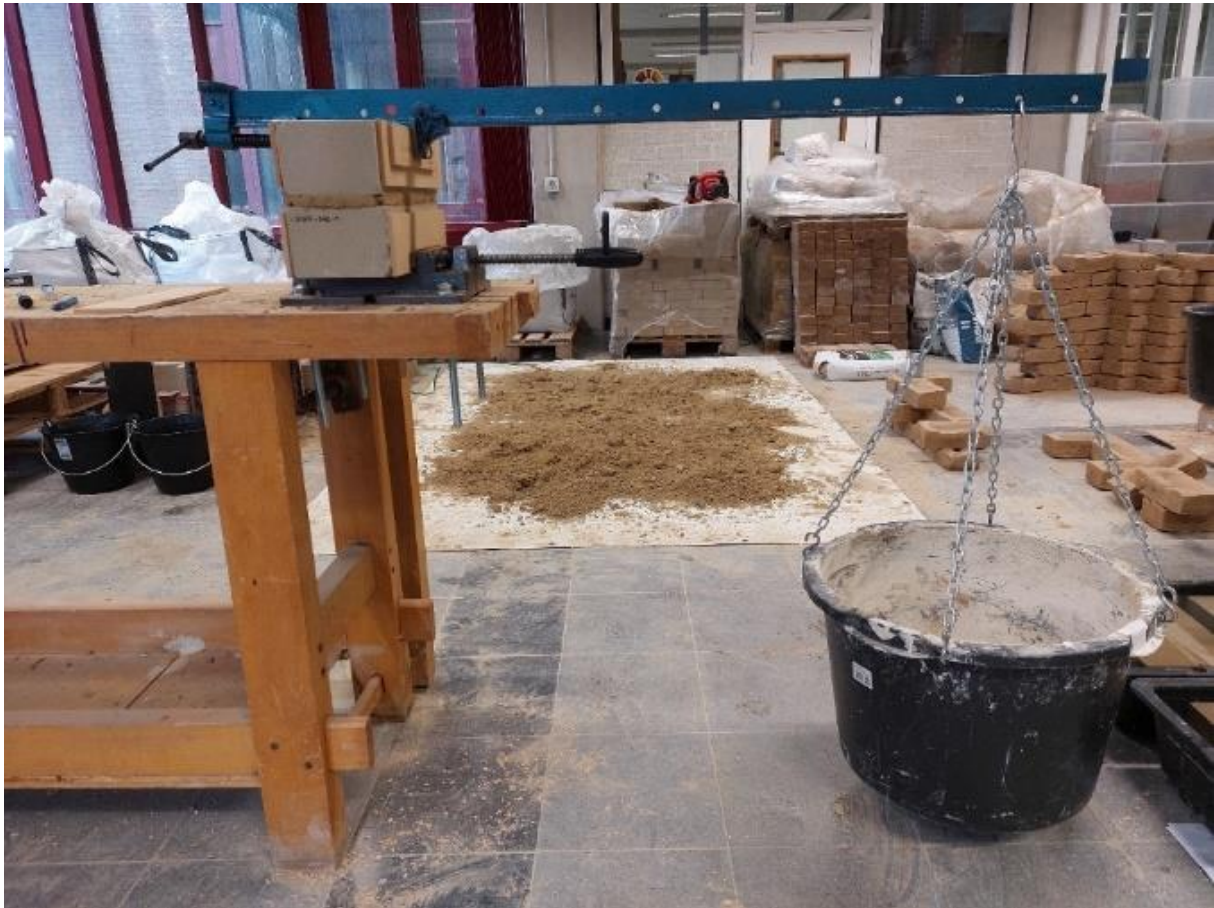
Figuur 16: Proefopstelling bond wrench test testreeks 1 en 2
