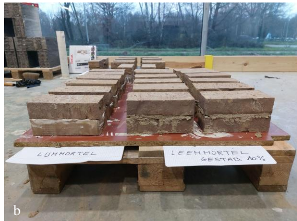
Figuur 19: Coupletten a) ongestabiliseerde leemmortel en b) gestabiliseerde leemmortel en lijm mortel
