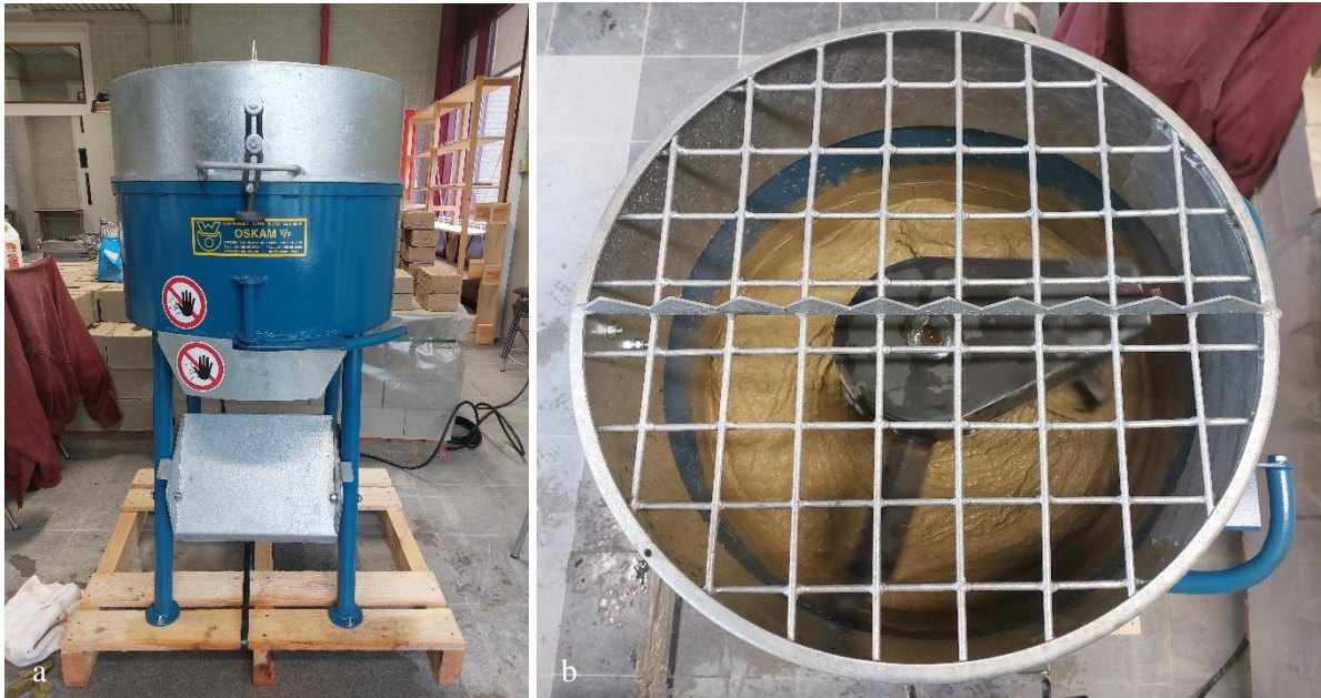
Figuur 58: a) gestandaardiseerde panmixer en b) mengproces
