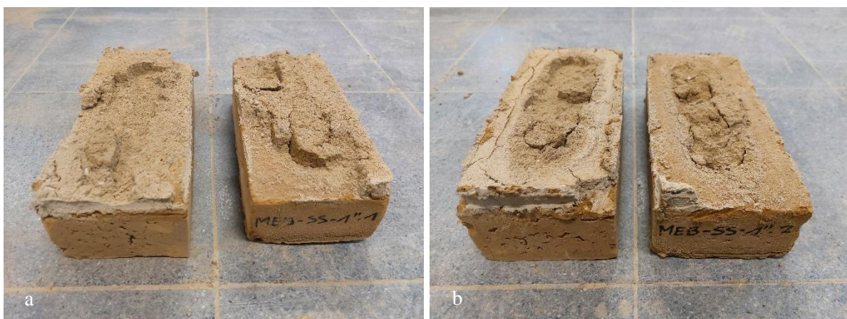
Figuur 72: Visualisatie faalmodi combinatie FMEB-SS a) faalmodus A3 en b) faalmodus A4
