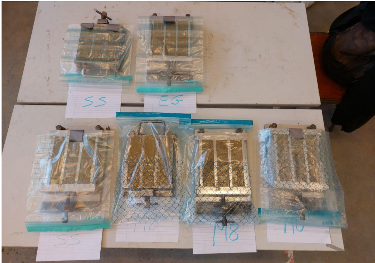
Figuur 32: Verse mortelbalkjes afgedekt of ingepakt met PE-folie
