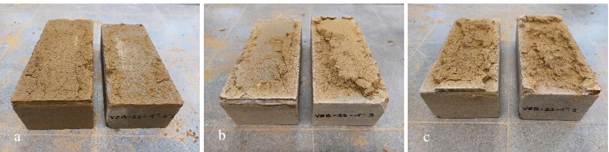
Figuur 76: Visualisatie faalmodi combinatie VEB4-SS a) faalmodus A2, b) faalmodus A3 en c) faalmodus A4
