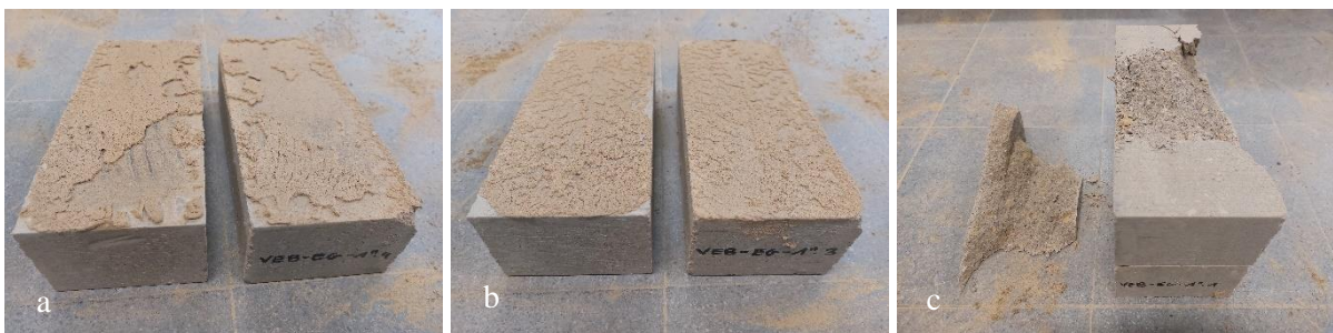
Figuur 75: Visualisatie faalmodi combinatie VEB4-EG a) faalmodus A3, b) faalmodus A4 en c) faalmodus A7
