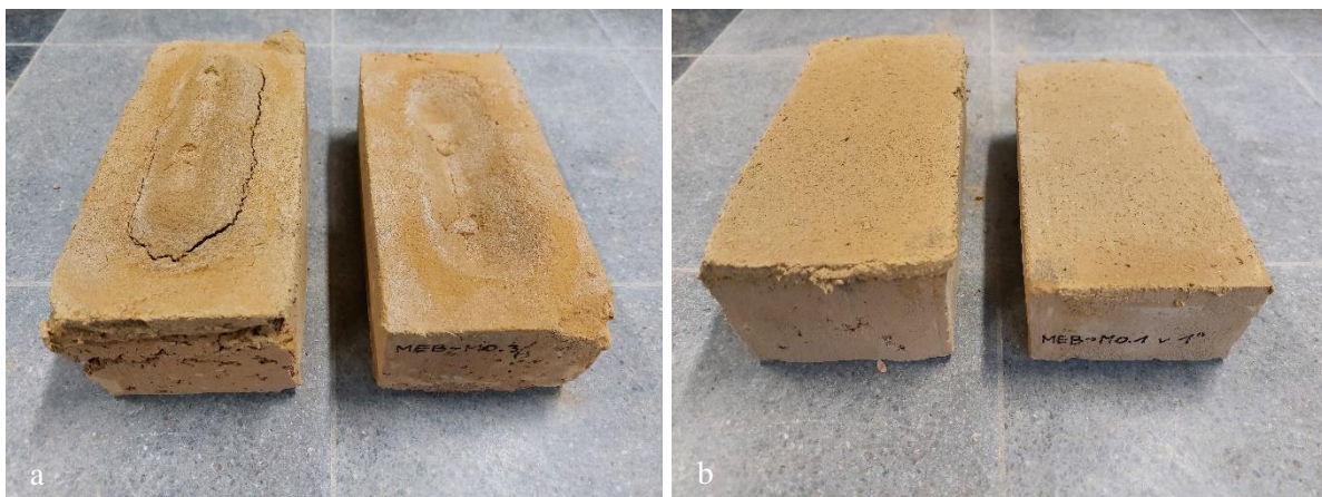
Figuur 50: Visualisatie faalmodi a) combinatie FMEB-M0 faalmodus A6 en b) combinatie MEB-M0 faalmodus A2
