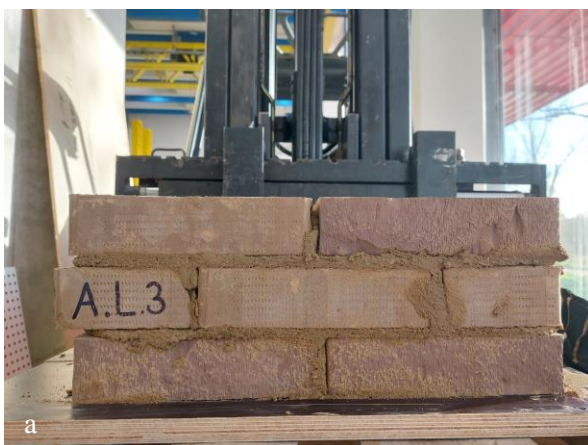
Figuur 20: Muurtje a) ongestabiliseerde leemmortel en b) kalkmortel
