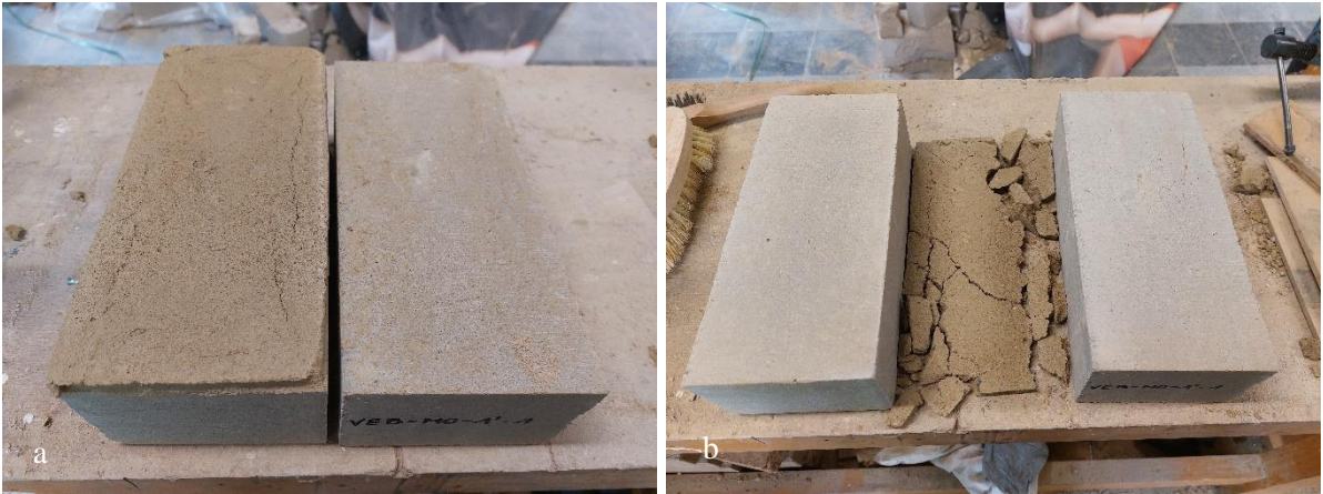
Figuur 84: Combinatie VEB4-M0 a) voor zuiver maken en b) na zuiver maken
