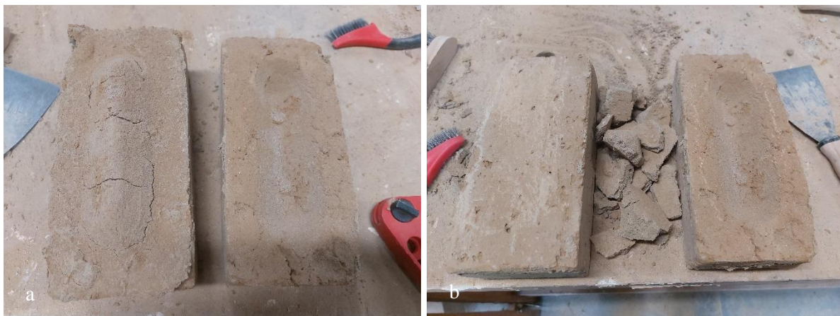
Figuur 80: Combinatie FMEB-M0 a) voor zuiver maken en b) na zuiver maken
