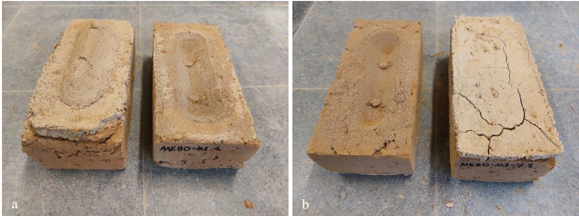
Figuur 51: Visualisatie faalmodi combinatie FMEB-M8 a) faalmodus A6 en b) faalmodus A1
