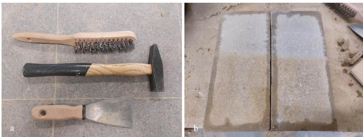
Figuur 79: a) gebruikte materiaal (staalborstel, hamer en spatel) en b) effect van staalborstel op steenoppervlak
