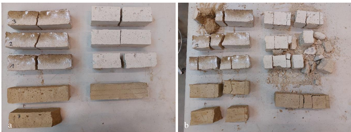
Figuur 36: Schadepatronen a) na buigproef en b) na buig- en drukproef
