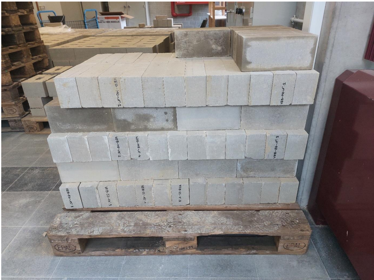
Figuur 88: Alle zuiver gemaakte vibro-compactieleemstenen
