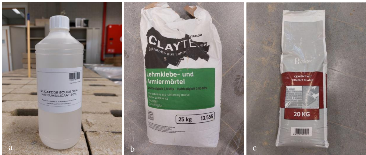
Figuur 39: a) sodiumsilycaat, b) leemlijmmortel en c) CEM II/B-LL 42,5 N
