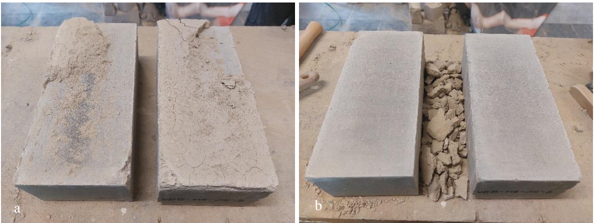
Figuur 85: Combinatie VEB4-M8 a) voor zuiver maken en b) na zuiver maken
