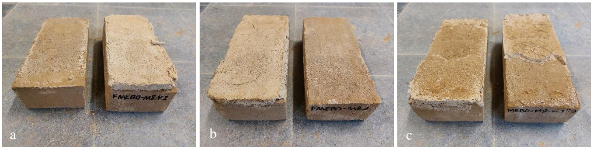
Figuur 52: Visualisatie faalmodi combinatie MEB-M8 a) faalmodus A1, b) faalmodus A2 en c) faalmodus A3
