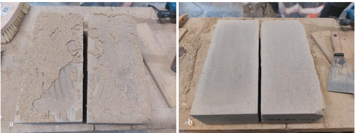
Figuur 86: Combinatie VEB4-EG a) voor zuiver maken en b) na zuiver maken
