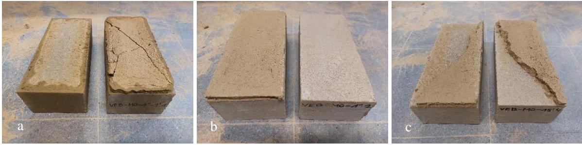
Figuur 73: Visualisatie faalmodi combinatie VEB4-M0 a) faalmodus A1, b) faalmodus A2 en c) faalmodus A3
