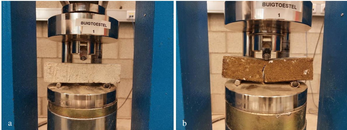
Figuur 34: Driepuntbuigproef van a) proefstuk M8 voor faling en b) proefstuk SS na faling
