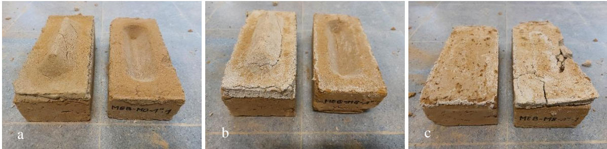
Figuur 70: Visualisatie faalmodi a) combinatie FMEB-M0 faalmodus A6, b) combinatie FMEB-M8 faalmodus A6 en c) combinatie FMEB-M8 faalmodus A1
