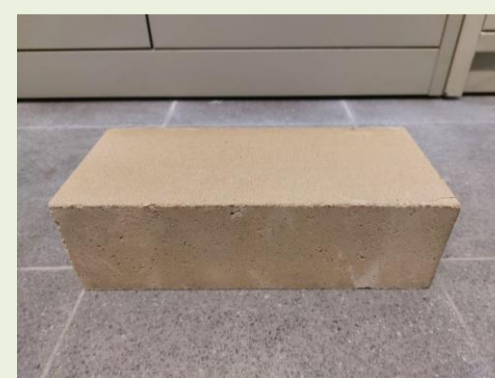
Figuur 2: Vibro-gecompacteerde leemsteen
