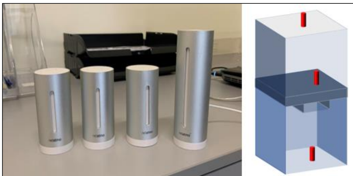
Figuur 37: CO 2 -sensoren a) binnenmodules en weerstation Netatmo b) locatie sensoren professionele vitrine (schematisch)
