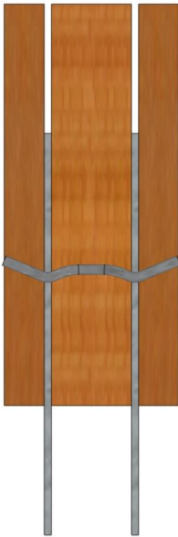
Figuur 6-1: Verbindingsconfiguraties uit proeven van Rossi met kenmerkende deuvelforming voor elke bezwijkcombinatie
