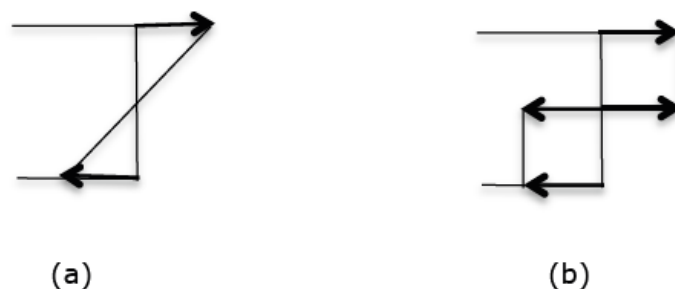
Figuur 2-9: Elastische (a) en plastische (b) spanningsverdeling in een metalen verbindingsmiddel [10]
