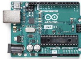
Figuur 63: Arduino Uno[36]
