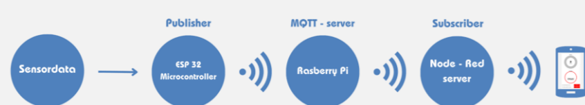
Figuur 5: Schematische voorstelling MQTT-protocol
